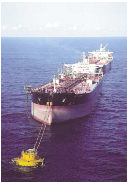
Рис. 9.1. Завантаження танкера нафтою з використанням точкового причалу
